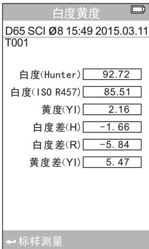
图27 白度黄度试样测量界面
